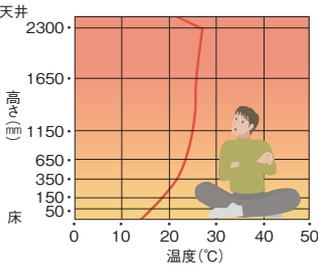
暖房器具を設置した部屋の温度を高さ別に測定。エアコンでは天井から床にいくにつれて温度が下がっていくのに対し、床暖房では足元から暖かく、頭の先まで均一に温度が広がってます。
